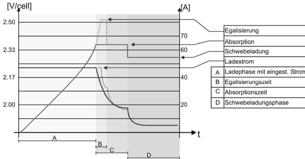
**4.6.2 Spannungsschwellen der Batterie (Grundeinstellung)**
